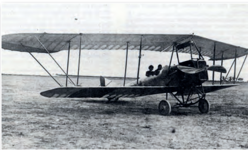
Barrón Flecha con motor Hispano de 140 CV
