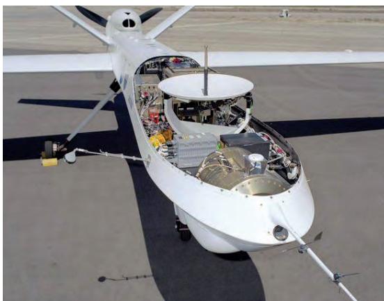
Antena del satélite y sensores del MQ-9 Reaper.
