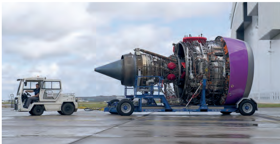
El motor Trent XWB-97 enviado por Rolls-Royce a Airbus para ensayos en un A380. -Airbus-
