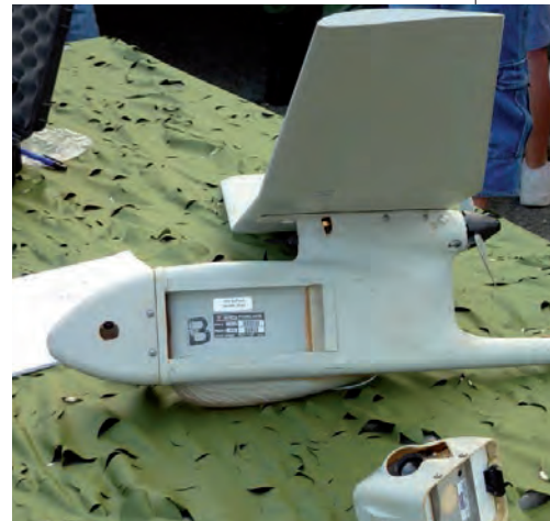
AeroVironment RQ-11 Raven. Batería de ion litio
