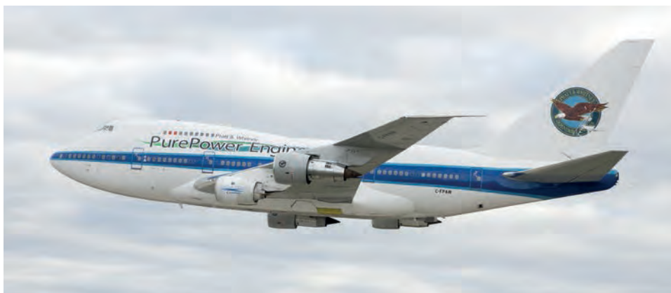
El Boeing 747SP de Pratt & Whitney en el curso del primer vuelo del motor PW1900G. -Pratt & Whitney-
