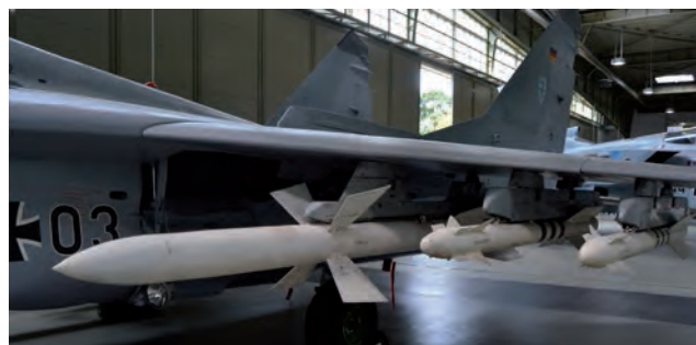
Bajo el ala y en la parte interior se encuentra un misil aire-aire Vympel R-27R (AA-10 "Alamo"). Este ingenio puede superar los 100 kilómetros de distancia con una carga explosiva de 40 kilos (foto P. Redón).
