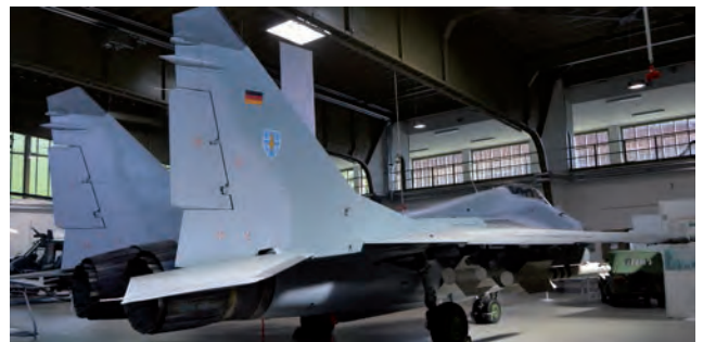
Mediante esta vista trasera del MiG-29 de Gatow, vemos el empenaje de cola con sus partes móviles y las alarmas radar, las toberas de las plantas motrices y los grandes planos de profundidad móviles (foto P. Redón).
