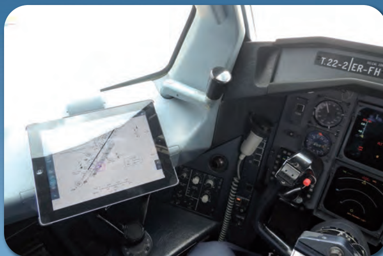
Posición y anclaje de iPad en Airbus 310 (T22).
