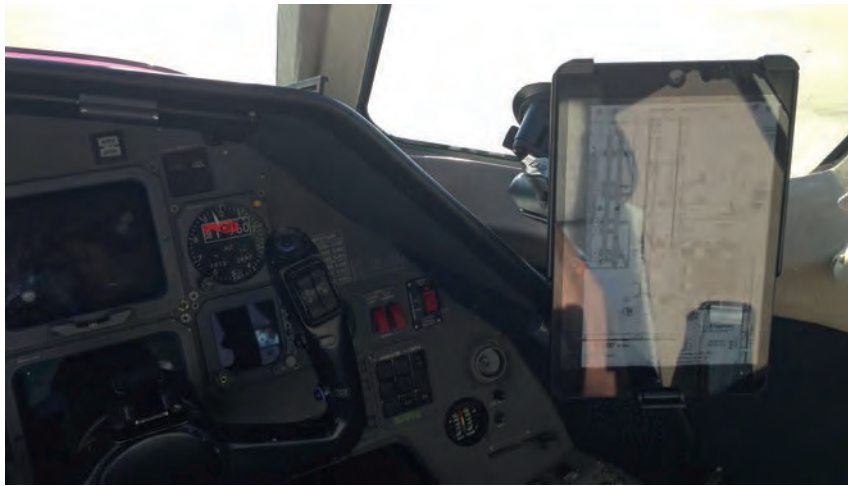
Posición y anclaje de iPad Mini en Falcon 900 (T18).
