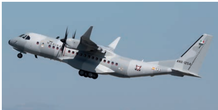
El nuevo Airbus C295W equipado con “winglets”.
