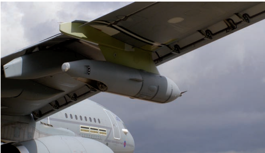
Detalle del pod Cobham, que se sitúan en la parte inferior de las alas de los A330 MRTT. Foto: MilborneOne.
