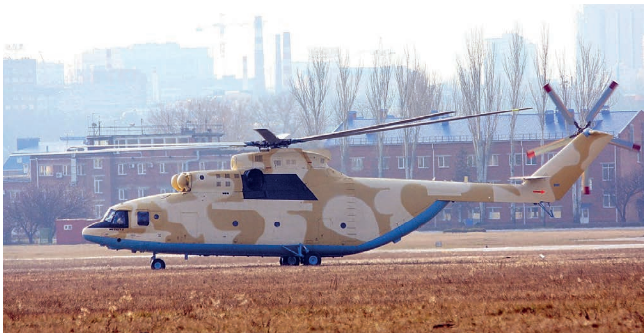
Argelia cuenta con 6 helicópteros de transporte pesado Mil Mi-26T2 con capacidad todotiempo.
