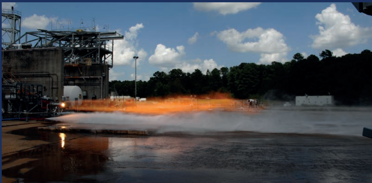
Esta prueba demostró la resistencia de piezas fabricadas con impresión en 3D, para futuros motores del SLS. (Foto: NASA/David Olive)
