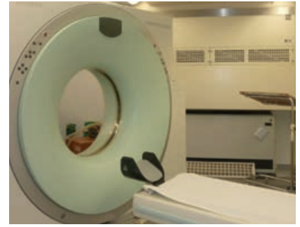
Tomógrafo computerizado en contenedor expandible plomado (año 2009).
