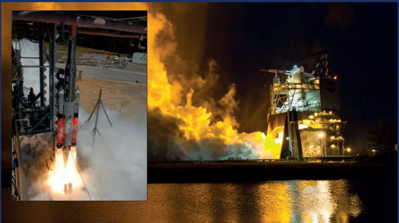
Ensayo de un motor RS-25 para el programa SLS y pruebas acústicas con un modelo en fase de lanzamiento. (Foto: NASA/David Olive)
