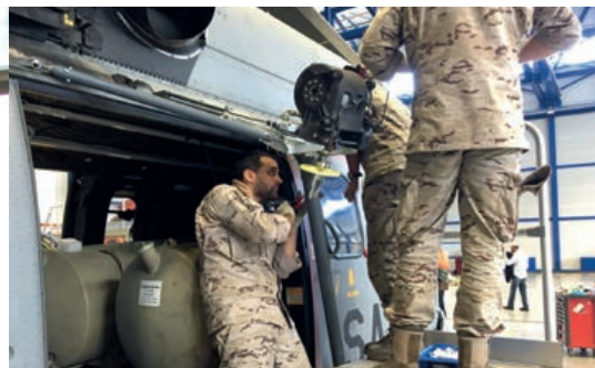
Mecánicos de la MAESMA y del Ala 46 durante el montaje de la Grúa de izado y los depósitos ferry.
