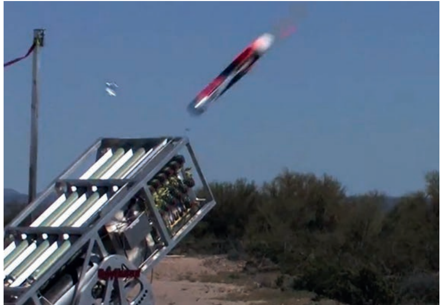
Programa LOCUST. Lanzador multitubo de Coyotes.
