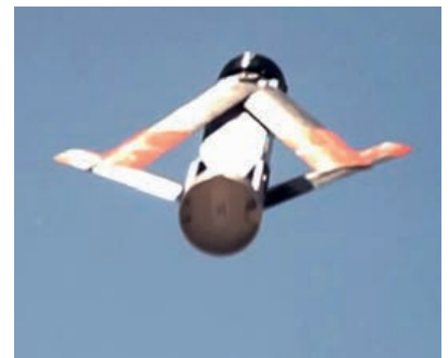
Programa LOCUST. Despliegue de las superficies de vuelo de un Coyote.
