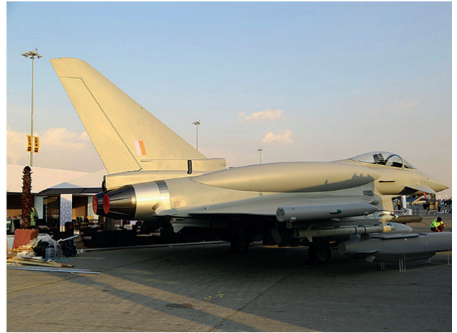
Maquetas a tamaño real del Eurofighter equipado con CFTs. (Imágenes de GTWiner's y AINonline respectivamente)
