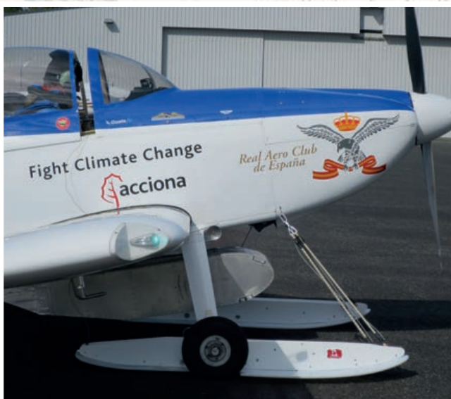
Avión RV8 con los esquís instalados.
