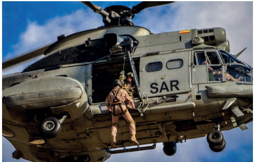
El operador de grúa comienza a bajar al rescatador después de que éste, le de el ok de encontrarse preparado y listo.
