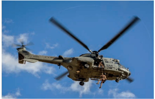
El helicóptero se encuentra realizando la maniobra de traslación hacia el objetivo, según las indicaciones que le da el operador de grúa al piloto, a la vez que va bajando al rescatador.
