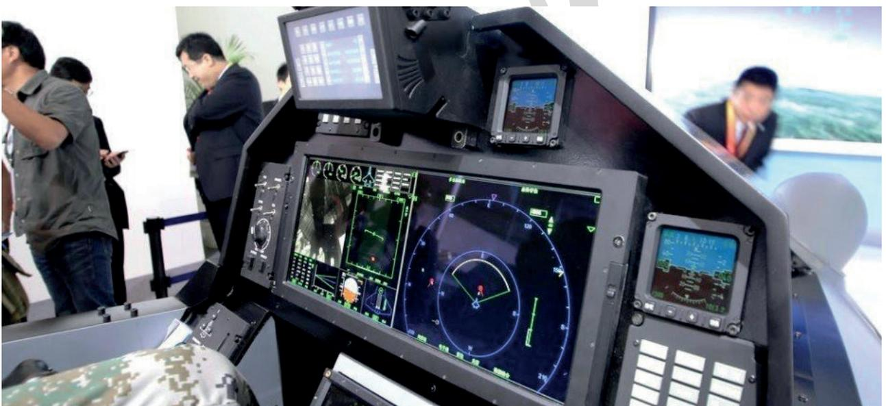
Imagen del cockpit del J-31. A destacar el HUD de gran angular y el WAD. (Imagen mil.huanqiu.com)
