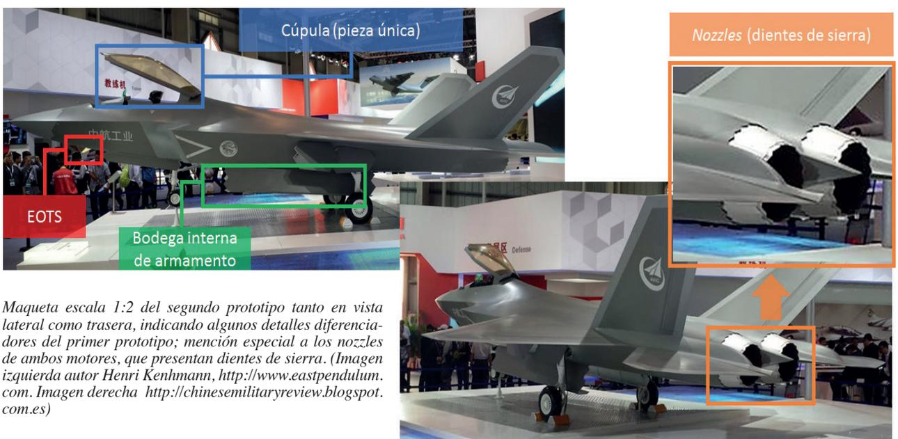
Maqueta escala 1:2 del segundo prototipo tanto en vista lateral como trasera, indicando algunos detalles diferenciadores del primer prototipo; mención especial a los *nozzles* de ambos motores, que presentan dientes de sierra. (Imagen izquierda autor Henri Kenhmann, <http://www.eastpendulum.com>. Imagen derecha <http://chinesemilitaryreview.blogspot.com.es>)
