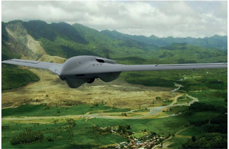
una carga útil de cien libras. Esta carga útil incluye sistemas de vigilancia en las bandas electro óptica e infrarroja, repetidores de comunicaciones de voz, enlaces de comunicación vía satélite y sistemas de inteligencia de señales.
