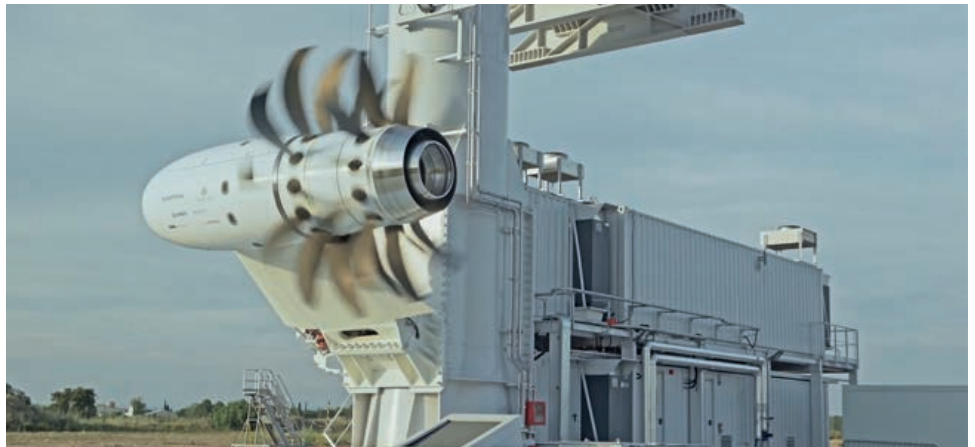
El demostrador CROR, Counter Rotating Open Rotor, de Safran en el banco de pruebas. -Safran-
