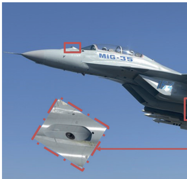
Localización de los sensores OLS en el avión (UEM y K) (foto: pública de MiG)
