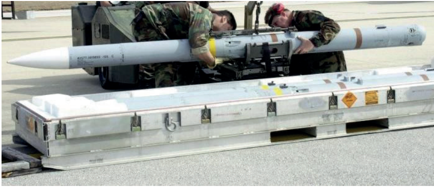
AIM-120C7 AMRAAM en contenedor AUR, donde caben cuatro misiles
