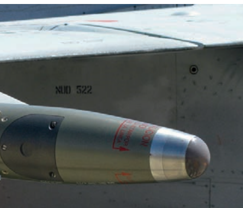
Detalle del seeker del misil AIM-9L
