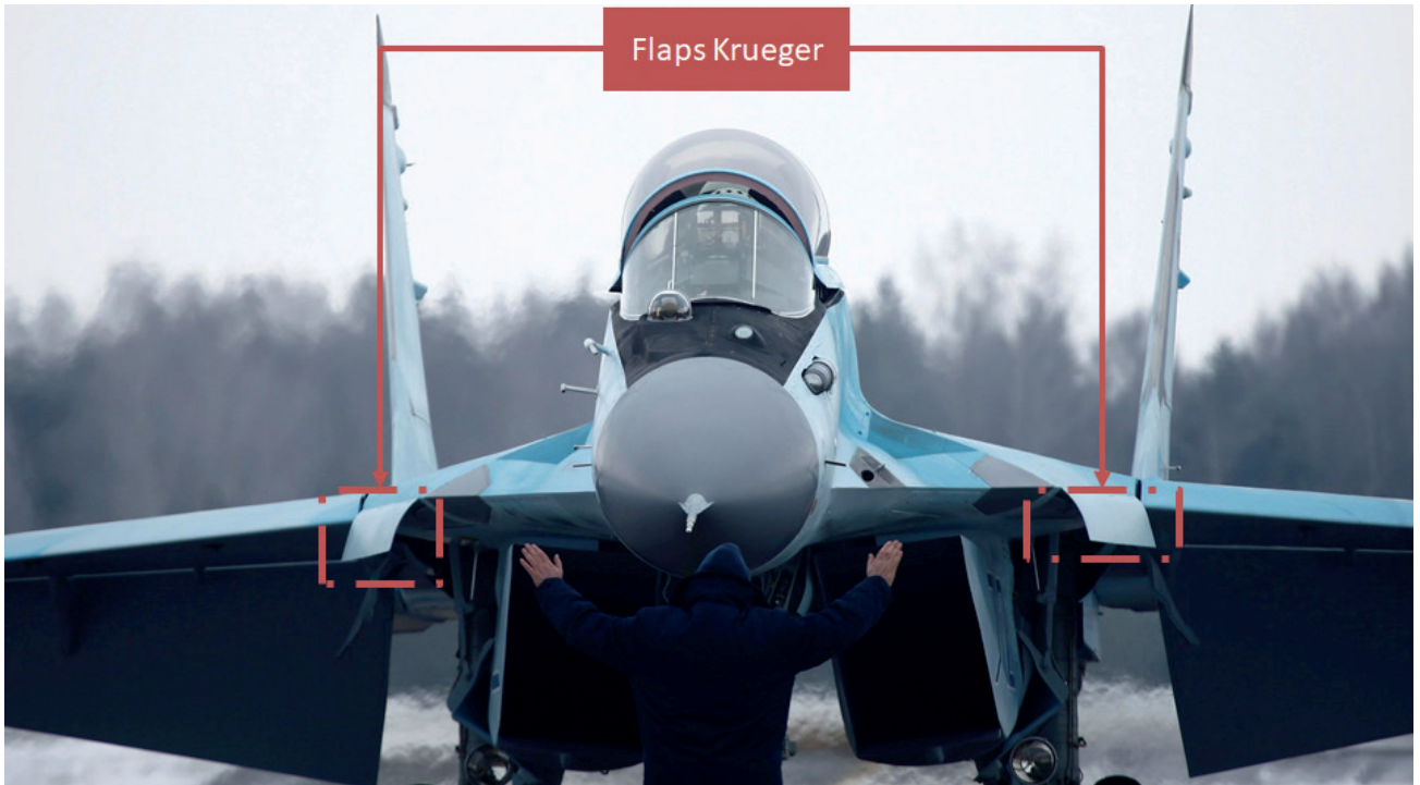
Imagen frontal del MiG-35, en la que se pueden apreciar tanto la inmensa superficie de los nuevos flaps del borde de salida, como los flaps de tipo Krueger situados en los LERXs (foto: desconocido)
