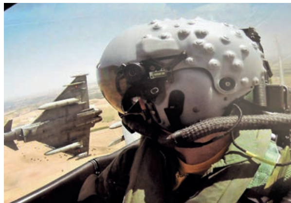
Simbología sobre el casco del C.16 (HMSS, Helmet Mounted Symbology System)
