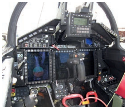
Cabina del MiG-29OVT utilizado para evaluación en vuelo, con configuración muy similar a la del MiG-35; nótese que en este, las etiquetas de los pulsadores e interruptores tienen etiquetas en inglés (foto: desconocido)
