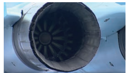
Toberas de escape del RD-33MK. MAKS 2017 (foto: obtenida de un vídeo de RUPTLY-RT)
