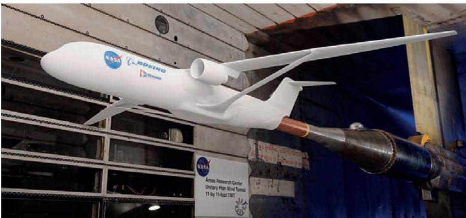
Ensayo de un concepto TTBW en el Ames Research Center de la NASA dentro del programa SUGAR. (Imagen: NASA)
