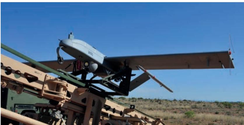
Un Shadow RQ-7B versión 2 instalado en un lanzador hidráulico. (Imagen: US Army)
