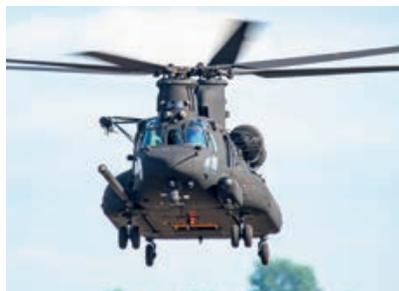
El bloque II incorpora un nuevo tren motriz, que incrementa el par motor en un nueve por ciento, nuevos depósitos de combustible con mayor capacidad y palas del rotor mejoradas. Todas estas características permiten al bloque II transportar más carga y equipos que modelos previos, con una capacidad total de 22 000 libras.
