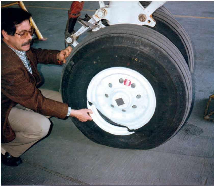
Rotura parcial llanta exterior tren principal izquierdo
