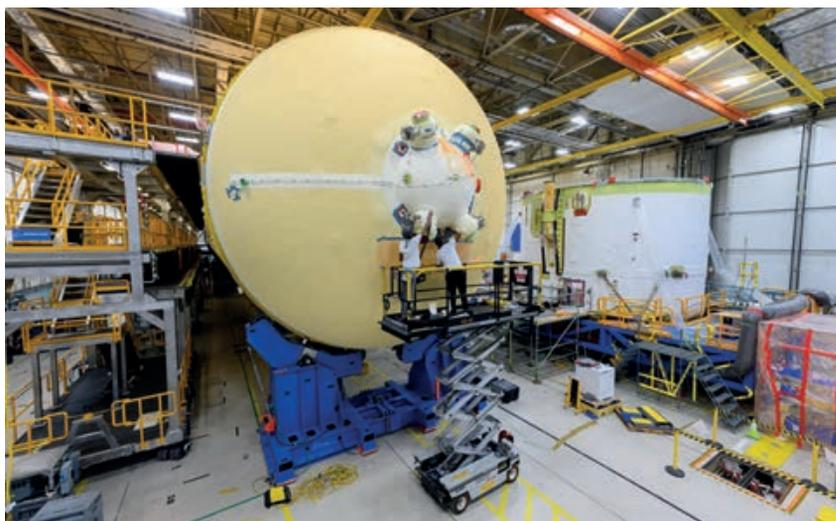
*La sección del motor es la última estructura importante que constituye la etapa central del cohete del Sistema de Lanzamiento Espacial de la NASA que ayudará a impulsar la misión Artemis II. (Imagen: NASA)*
