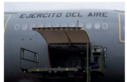
Detalle de una de las puertas que dan acceso a la bodega de carga. (Imagen: Ministerio de Defensa)
