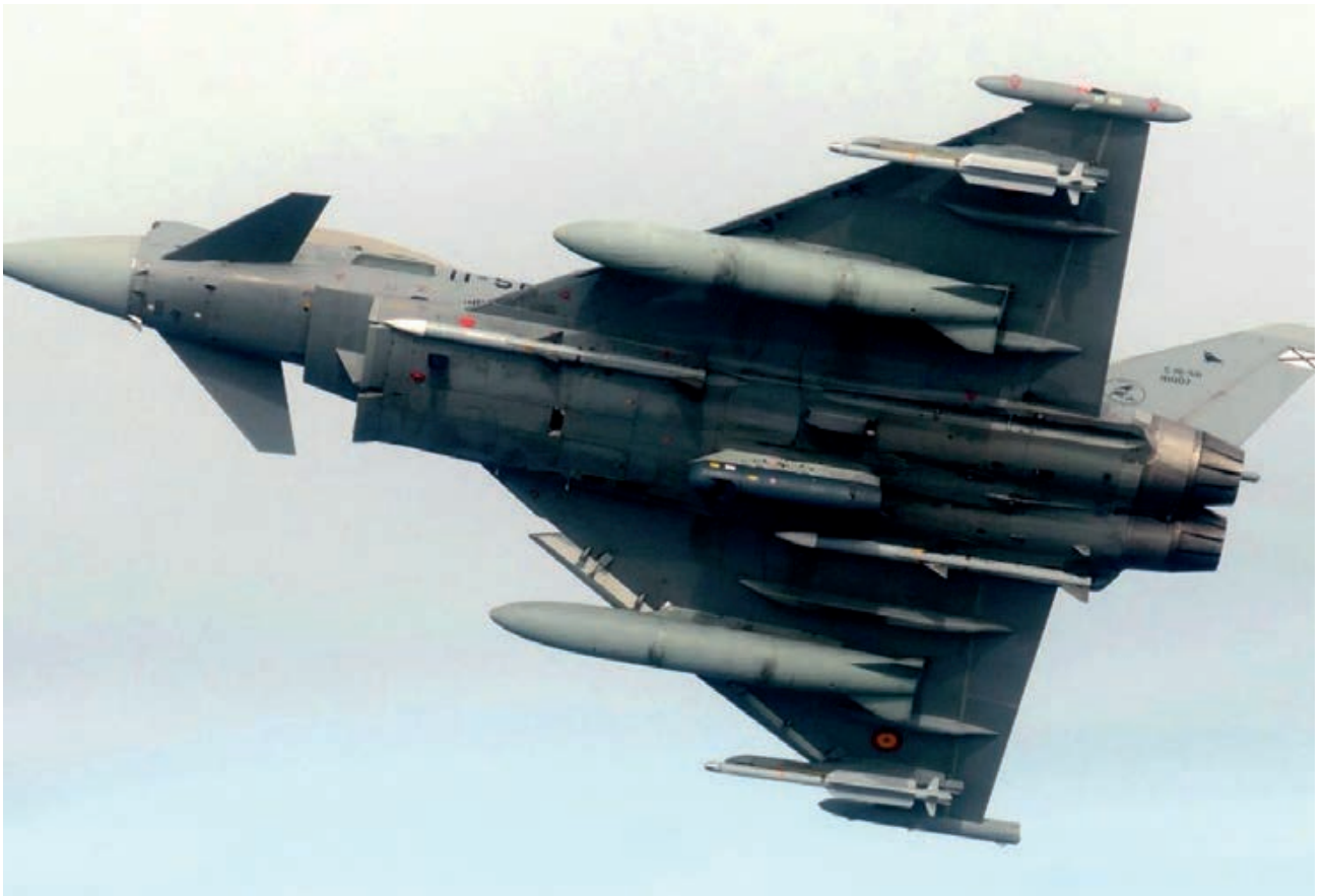
Eurofighter del Ala 11 con sendos AMRAAM semiembutidos. (Imagen: Ejército del Aire y del Espacio)
