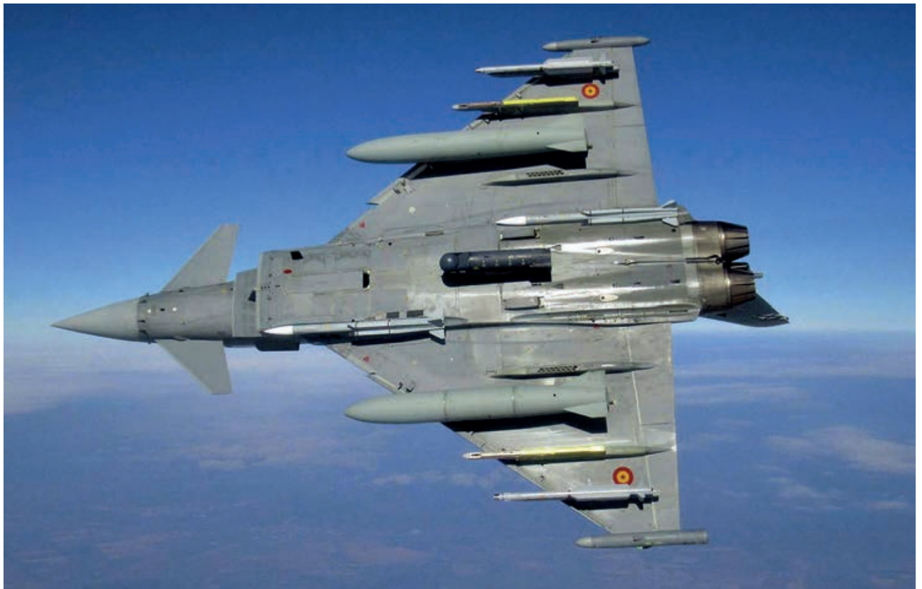
Eurofighter en Bulgaria con dos Meteor semiembutidos. (Imagen: Ejército del Aire y del Espacio)
