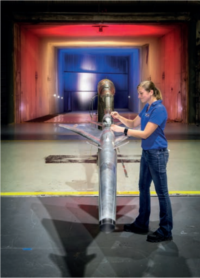
Maqueta del X-59 siendo preparada para pruebas en un túnel de viento. (Imagen: NASA)
