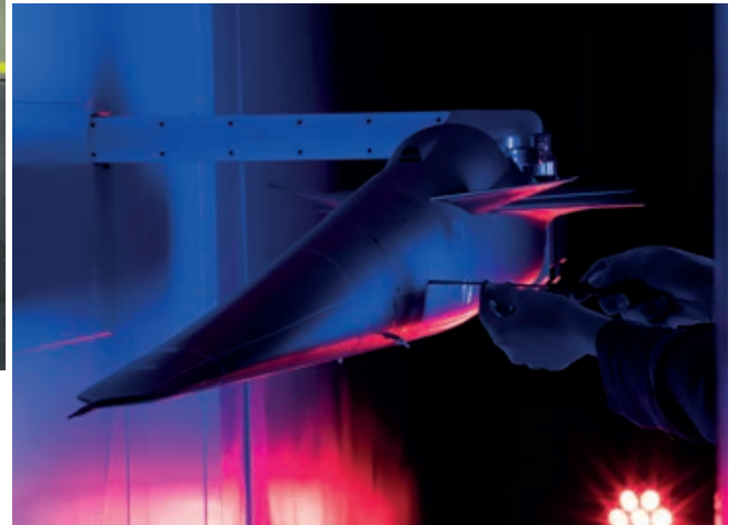
Las pruebas en túneles de viento han servido para validar algunas de las tecnologías implicadas en el proyecto. (Imagen: Lockheed Martin)
