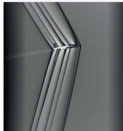
Los técnicos de la NASA usaron fotografía Schlieren para poner de manifiesto las ondas de choque de un avión T-38, y el método se usará también para el X-59. (Imagen: NASA)
