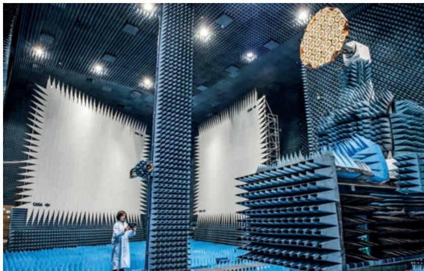
*Zona de prueba de antenas y RF híbrida europea Hertz de la ESA, anteriormente conocida como rango de prueba de carga útil compacta. Las paredes metálicas protegen las señales de radio exteriores, mientras que el revestimiento interior de espuma puntiaguda absorbe las señales de radio internamente para crear condiciones que simulan el vacío infinito del espacio. (Imagen: ESA)*
