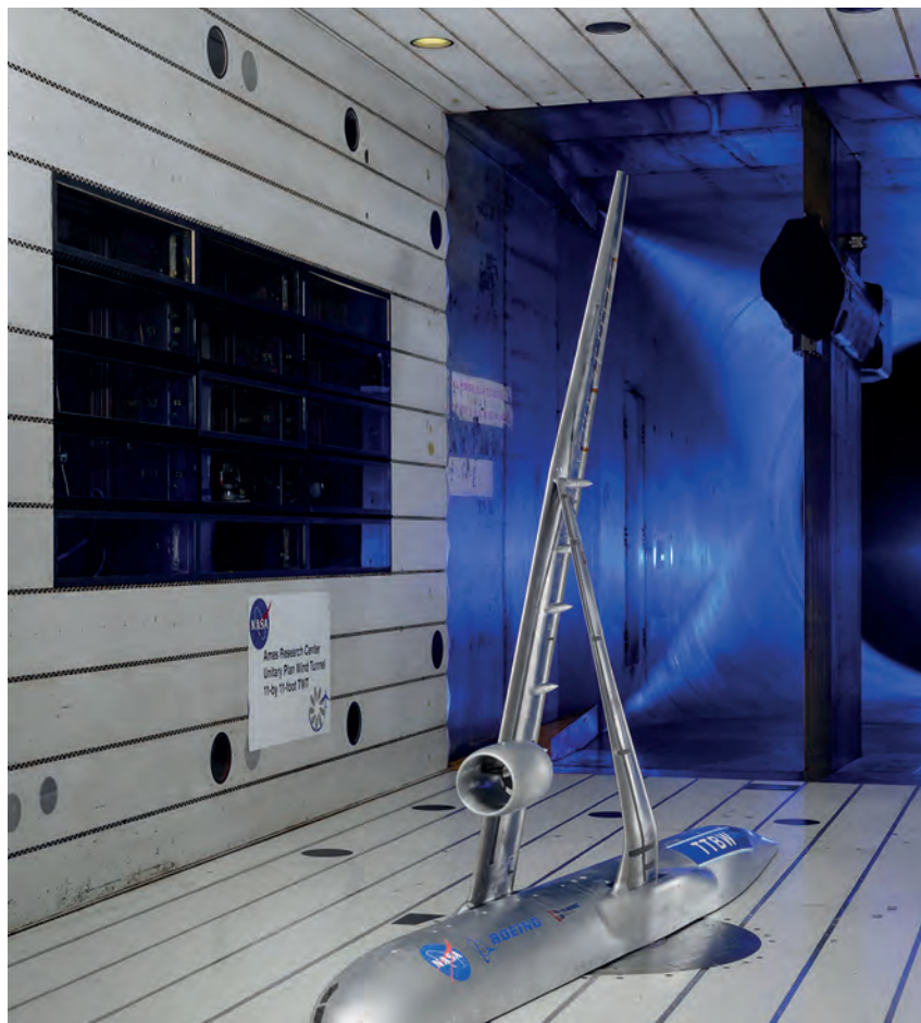
Ensayo en el túnel aerodinámico de 11x11 ft del Ames Research Center de una maqueta a escala 9% del TTBW en régimen transónico, durante la quinta fase del SUGAR (3 de febrero de 2022)
