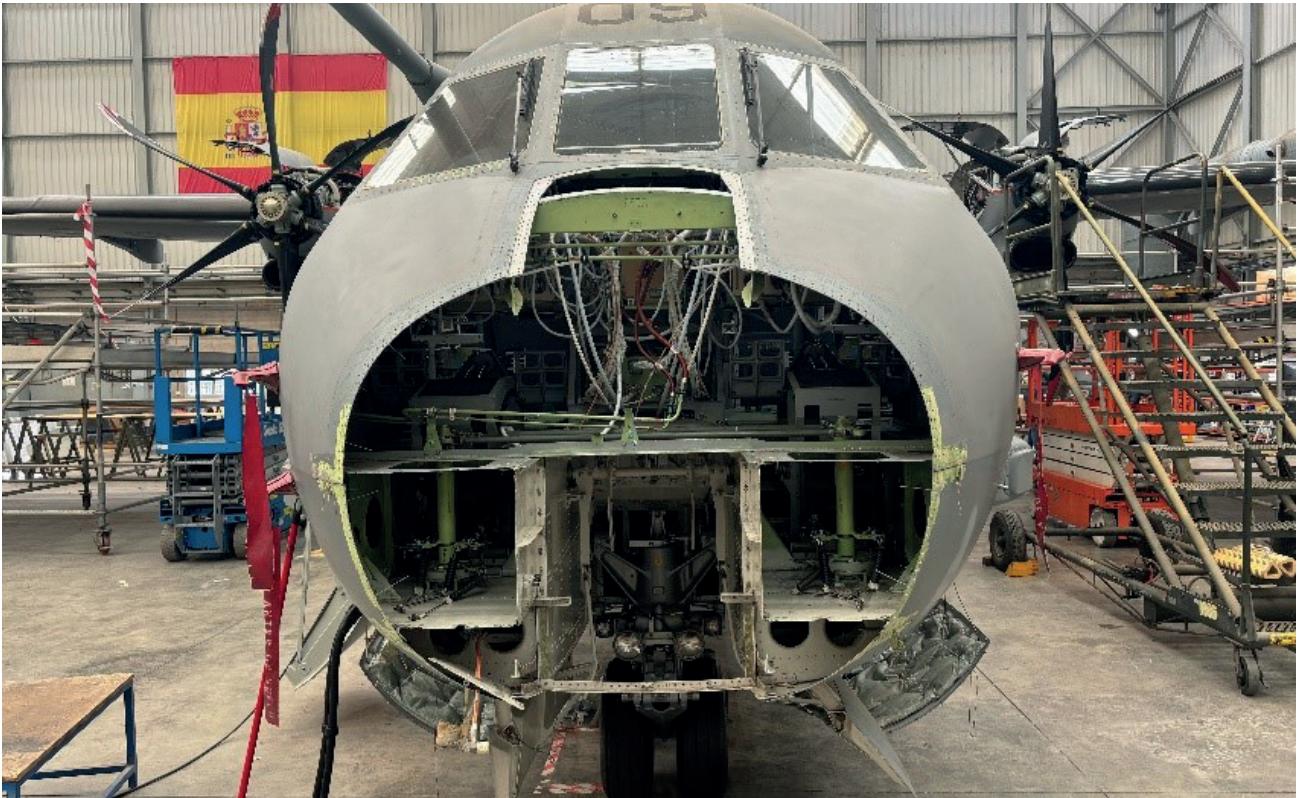
Avión T.21 en proceso de sustitución de una cuaderna
