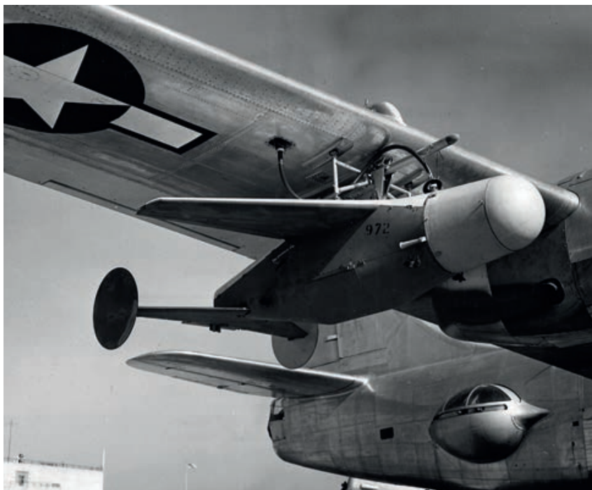
ASM-N-2 Bat cargado en un Consolidated PB4Y-2 Privateer. (Imagen: USNavy)
