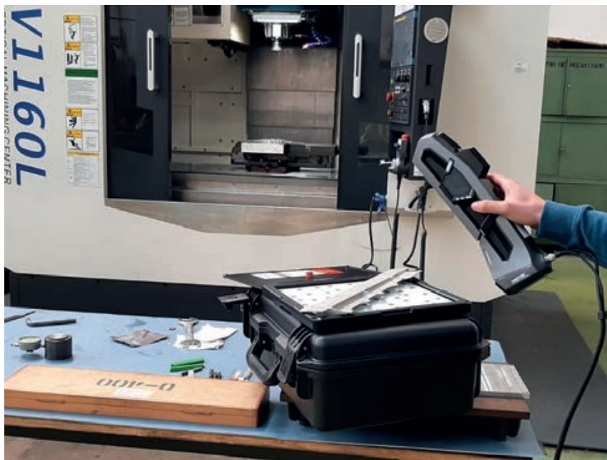
Escaneado de piezas y torno vertical de control numérico
