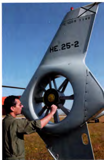
Un mecánico de la patrulla inspecciona el rotor de cola de un Colibrí .
