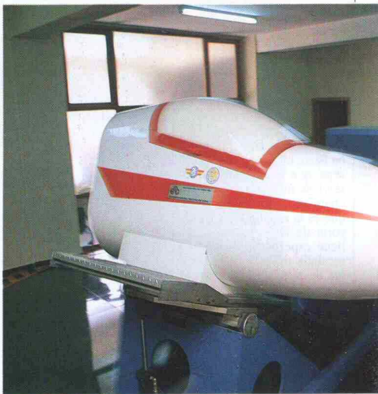
Vertifugo. Este simulador reproduce las sensaciones de desorientación espacial que pueden padecer los pilotos en la atmósfera.
