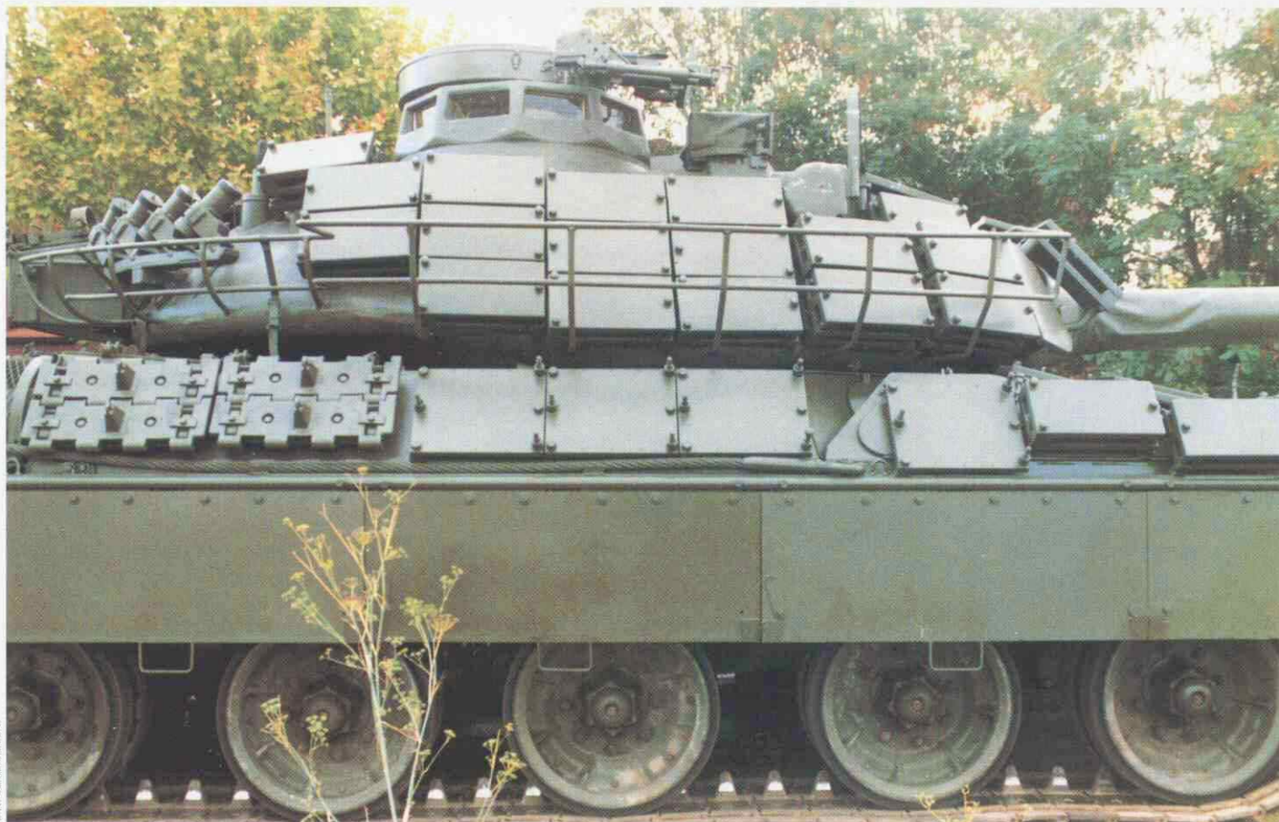
Escudo. El blindaje reactivo está constituido por módulos metálicos rellenos de explosivo que se atornillan en el exterior del carro.
