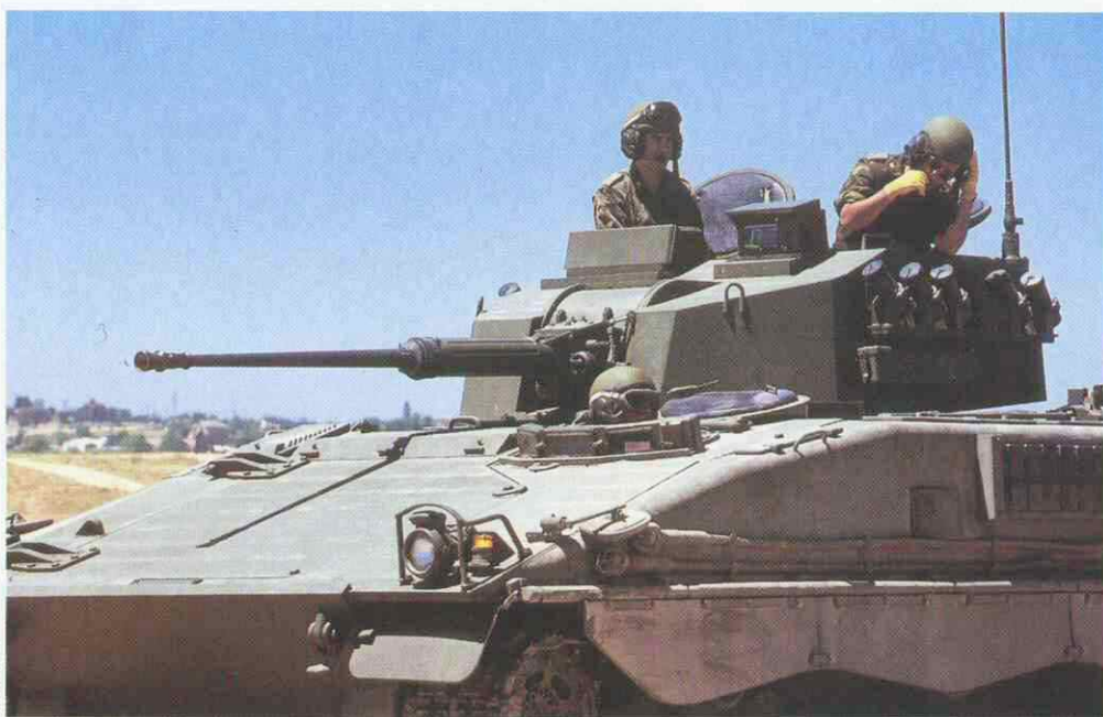
Pizarro. El nuevo vehículo de combate de Infantería/Caballería utilizará blindajes reactivos y cerámicos así como capas interiores de protección antifragmento especialmente diseñadas para él.
