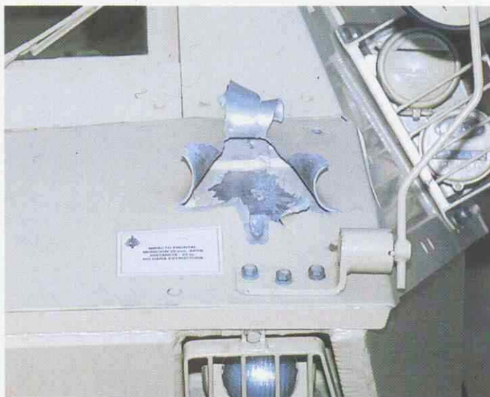
SABBLIC. Prueba del blindaje cerámico ligero en la proa de un BMR.
