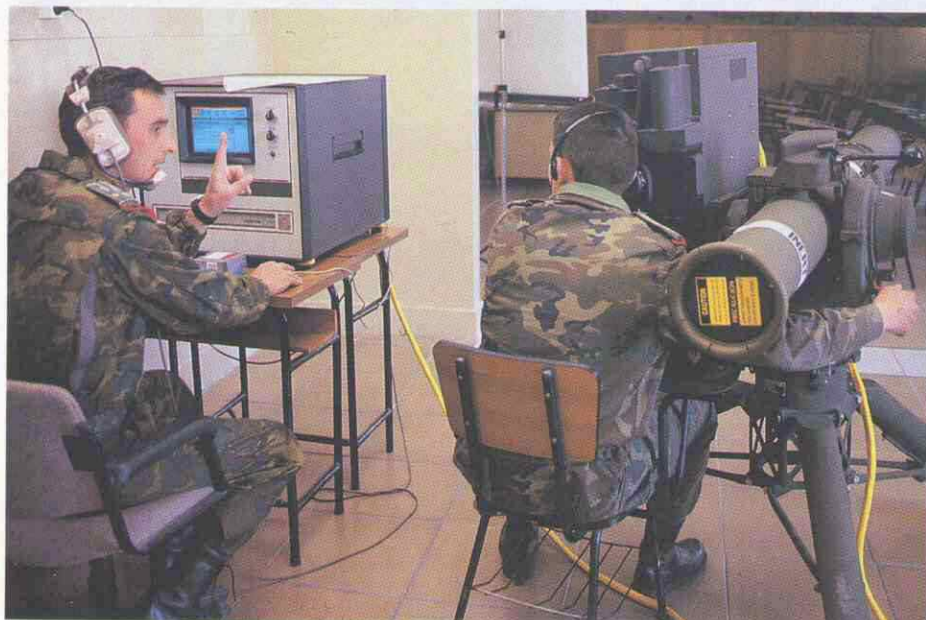
Enseñanza. Un profesor inicia a un alumno en el manejo del misil contracarro TOW (Tube Optical Wire) por medio de uno de los simuladores utilizados en la Academia toledana.
