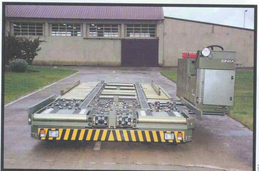
CARGA. La plataforma transportadora autopropulsada de EINSA destaca por su posibilidad de ser embarcada en aviones.
