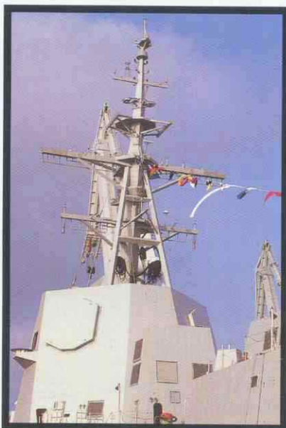
SPY-1D . Las antenas planas en la superestructura son características del radar del Aegis .
