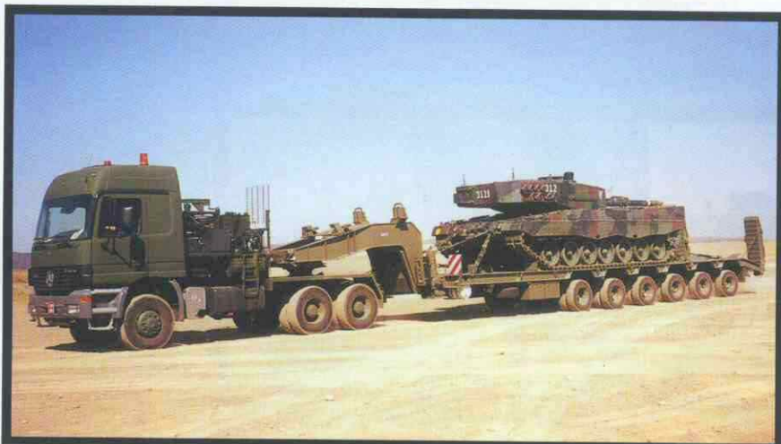
GÓNDOLA. La empresa Gontrailer ha desarrollado una nueva plataforma 6X6 de suspensión hidráulica para cargas de hasta 90 toneladas.
