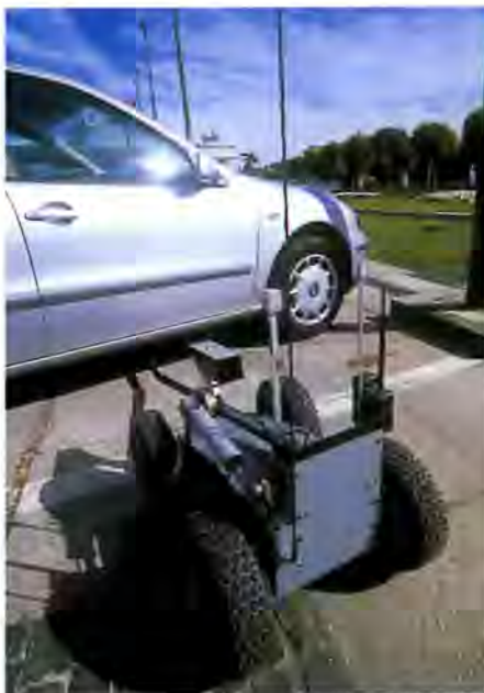
La versatilidad del robot le permite la inspección de lugares de difícil acceso, como los bajos de un automóvil.
