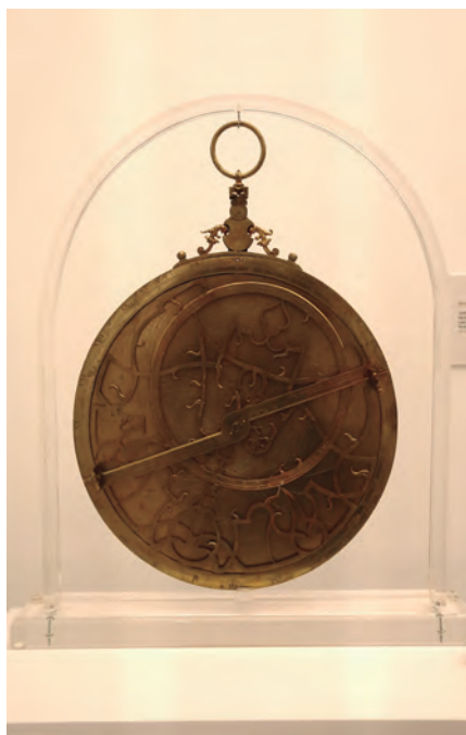
Astrolabio, instrumento de navegación usado para fijar la altura de los astros.
