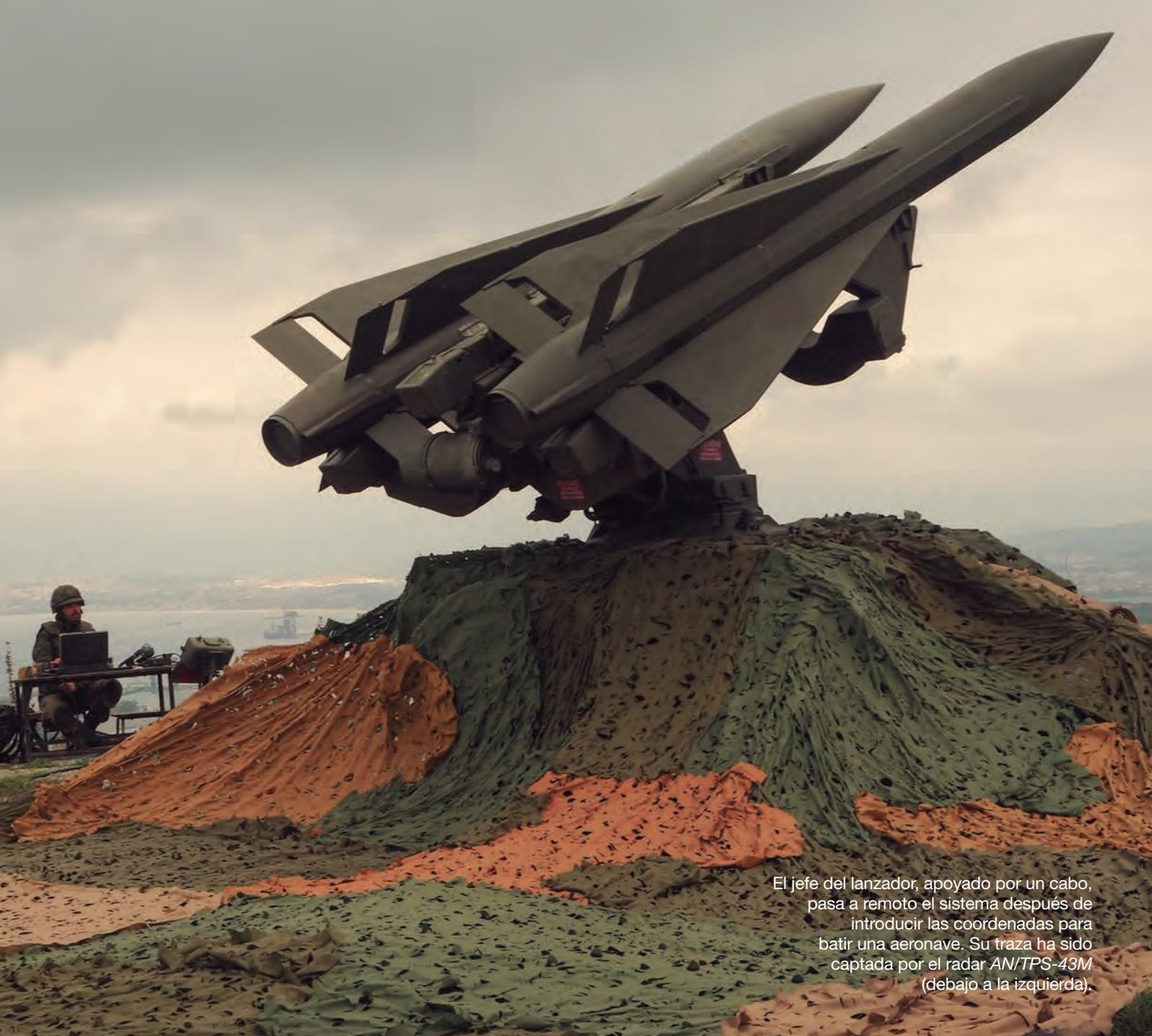
El jefe del lanzador, apoyado por un cabo, pasa a remoto el sistema después de introducir las coordenadas para batir una aeronave. Su traza ha sido captada por el radar AN/TPS-43M (debajo a la izquierda).
