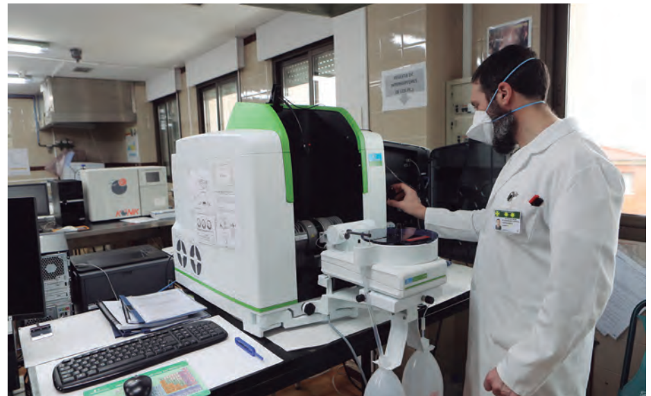
Se emplean espectroscopios, como en el que maneja en la imagen el teniente coronel Alberto Zamora, para detectar la presencia de elementos químicos en los alimentos.
