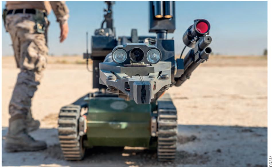
Robot de desactivación de explosivos empleado en las Fuerzas Armadas para la localización, identificación y manipulación de artefactos sospechosos.
