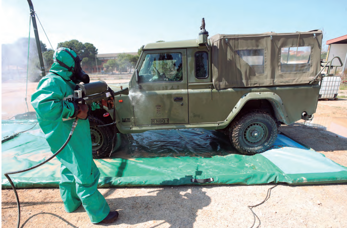
Las estaciones de descontaminación ligera, como la de la imagen, pueden «limpiar» cuatro vehículos y 30 personas en una hora.
