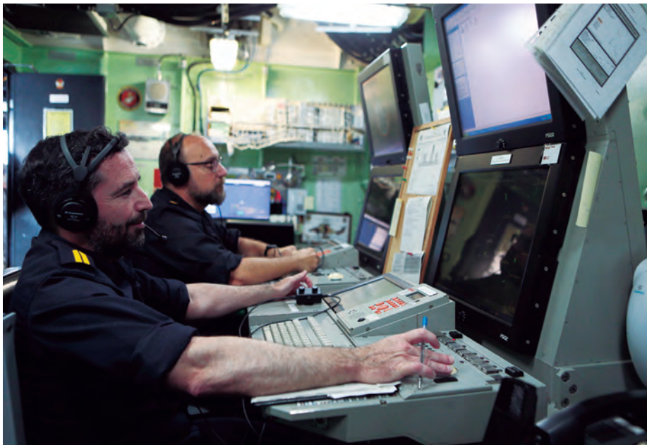
Desde el control de tránsito del Juan Carlos I dos operarios mantienen contacto permanente con las aeronaves mientras estas permanecen en vuelo y hasta su aproximación al buque.
