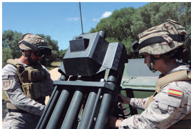
Operadores del mortero Eimos de 81 mm., que proporciona apoyos de fuego embarcado en un vehículo Vamtac .
