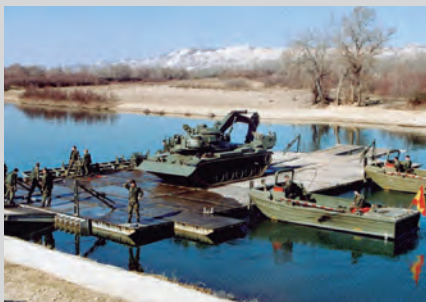
De Tablero Flotante (PTF) MAN. 1972/en servicio.
