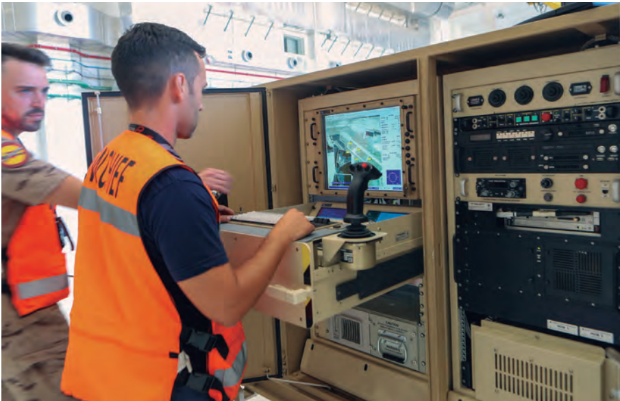
Dos mecánicos realizan el mantenimiento de los controles del avión. El monitor y la palanca de mando simulan en tierra la respuesta que les mandaría la palanca de mando del piloto en su cabina.
