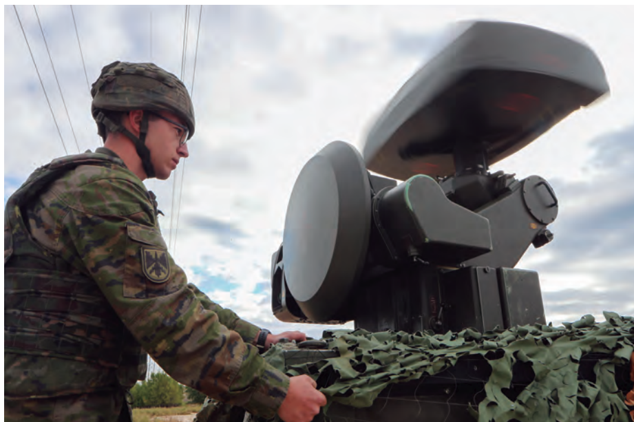
Operador de la unidad de sensores de la dirección de tiro 35/90 Skydor , sistema antiaéreo para baja y muy baja altura, con un alcance máximo efectivo de 4.000 metros.
