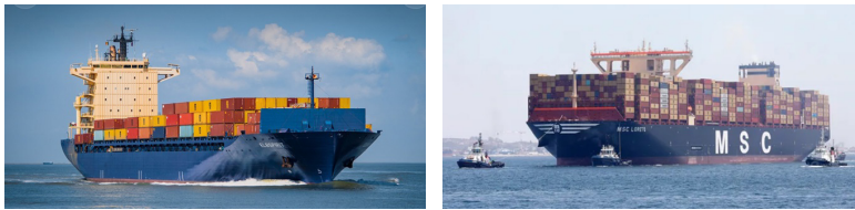
Buques portacontenedores Feeder y convencional. Fuente: SASEMAR
