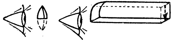
FIGS. 9 y 10.—Diseños aclaratorios del principio en que se basa el funcionamiento de la "lente de puntería".
