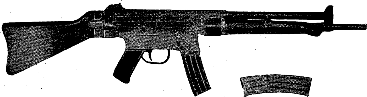
Arma automática francesa (en estudio), inspirada en el MP-44 alemán, disparando la munición americana de la carabina Garand, de calibre 7,62.
