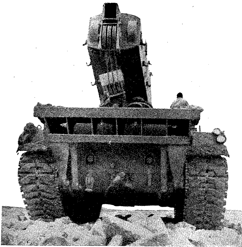
Un pesado remolque de carros M-51, sufriendo la prueba de paso por un "camino" de 180 m. formado con piedras sueltas de 60 cm. de ancho.
