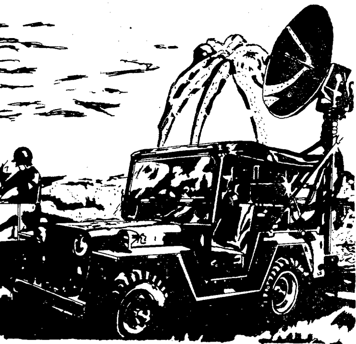
Estación terrestre para la red táctica de transmisión por satélite.
