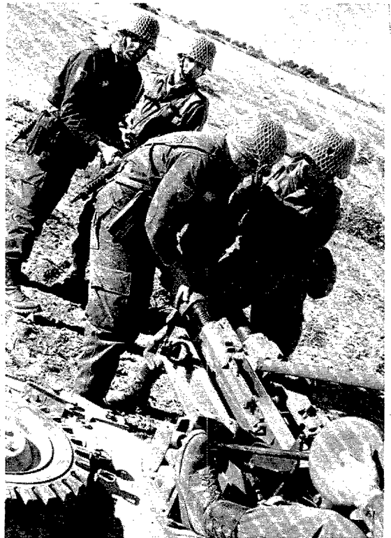
Cada doscientos disparos de tiro continuado es necesario cambiar los tubos. Los equipos formados por los cargadores y proveedores lo realizarán rápidamente, reduciendo el tiempo neutralizado de estas armas.
