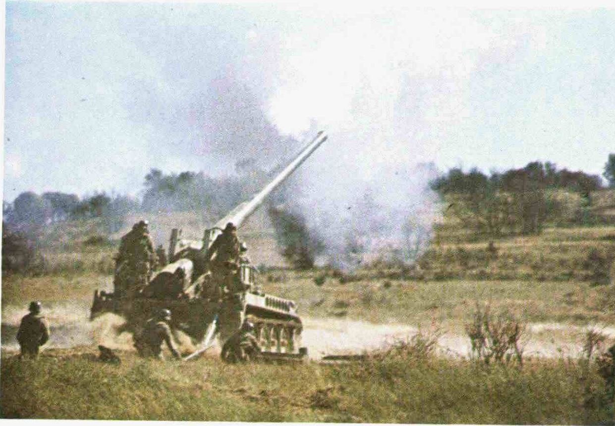
El gigantesco cañón de 175/60 acaba de hacer fuego. El tubo de 10,5 metros de longitud, despide una densa nube de gases, y en el suelo se levanta gran cantidad de polvo. Sus diez sirvientes están ya habituados al tremendo estampido del disparo.
