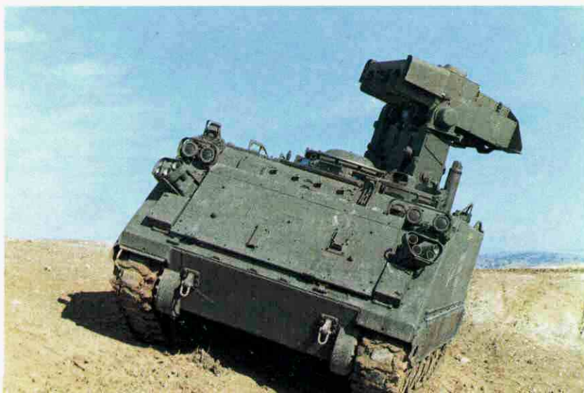
El ITV-M901, sistema lanzamisiles TOW, uno de los vehículos experimentados en la Academia para evaluar su posible inserción en las Unidades de nuestro Ejército.
