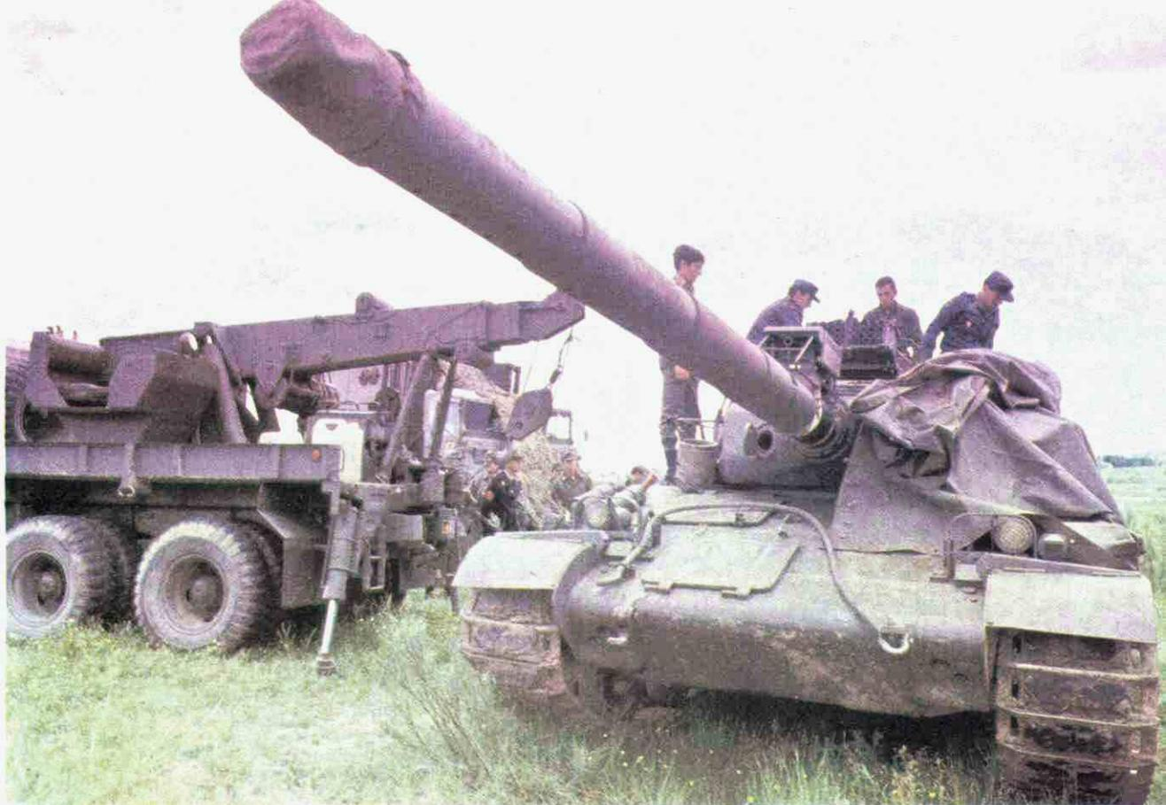
Un AMX-30, cuya torre precisa ser desmontada, en las inmediaciones de un camión-grúa. Presto para desplazarse rápidamente a cualquier sitio el personal de reparaciones desarrolla, en ejercicios y maniobras, un duro e intenso trabajo.
