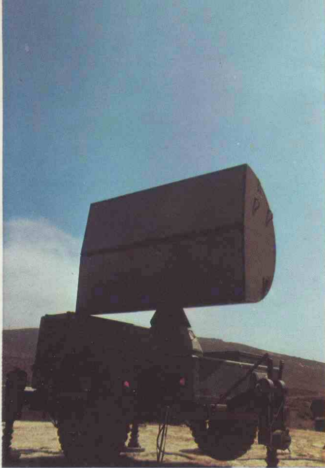
Radar de baja cota (CWAR).
