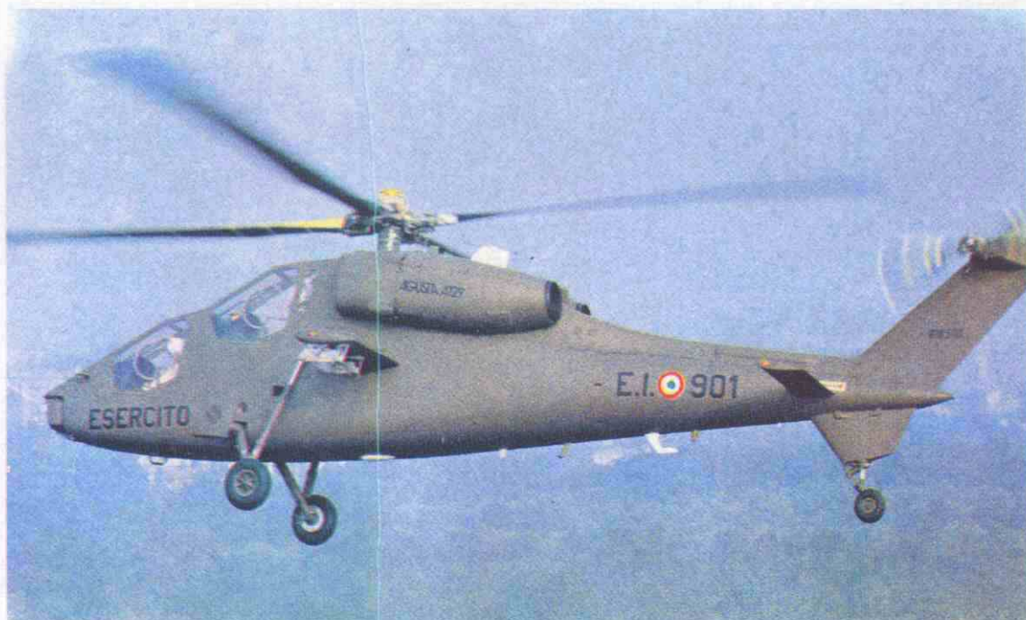
El Agusta A129 «MANGUSTA», prototipo de helicóptero para la lucha contracarro concebido en Italia para la Aviación Ligera del Ejército (ALE).
