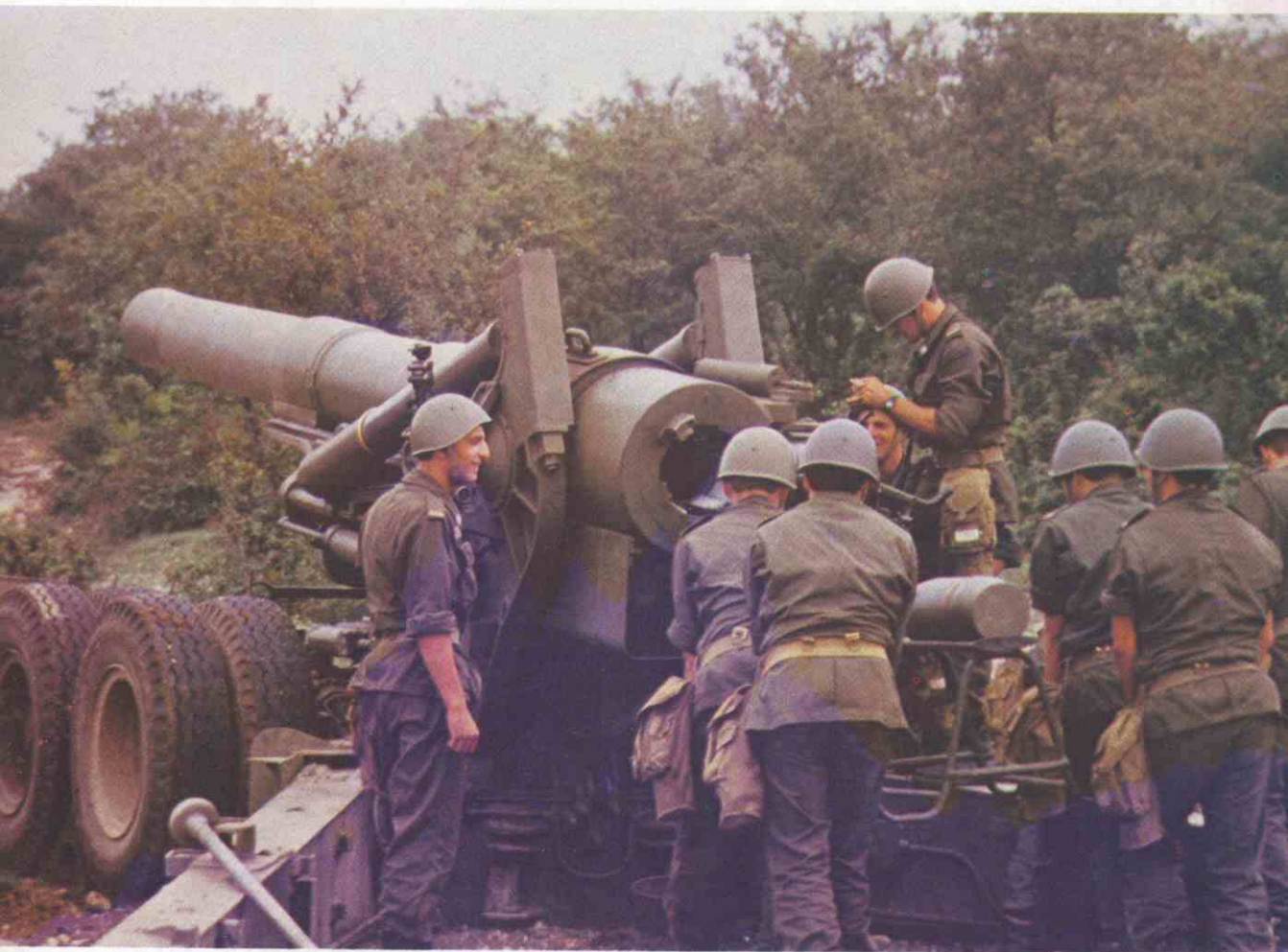
Obús remolcado de 203/25, en servicio en la Brigada de Misiles del Ejército.
