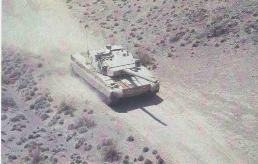
**El carro AMX-40 ofrece buenas características de movilidad y maniobrabilidad sobre todo terreno. Su cañón de 120 mm. con munición de energía cinética y dirección de tiro automático COSTAC, le confieren la necesaria potencia de fuego.**
