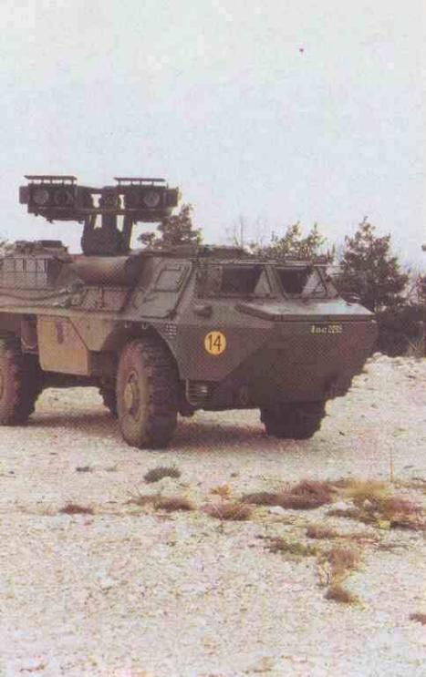
**VAB-4 x4 armado con la torre escamoteable Mephisto y lanzamisiles contracarro HOT.**
