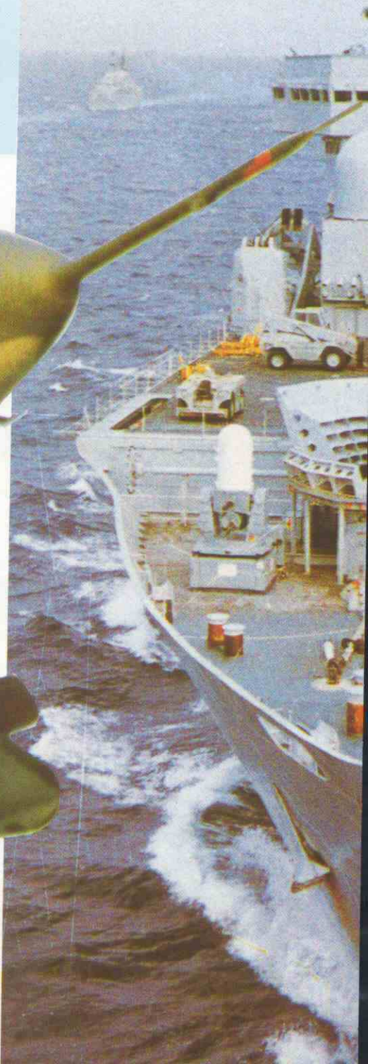
HMS “Invincible”. Dotado con montajes PHA LANX cerca de los lanzadores de proa.
